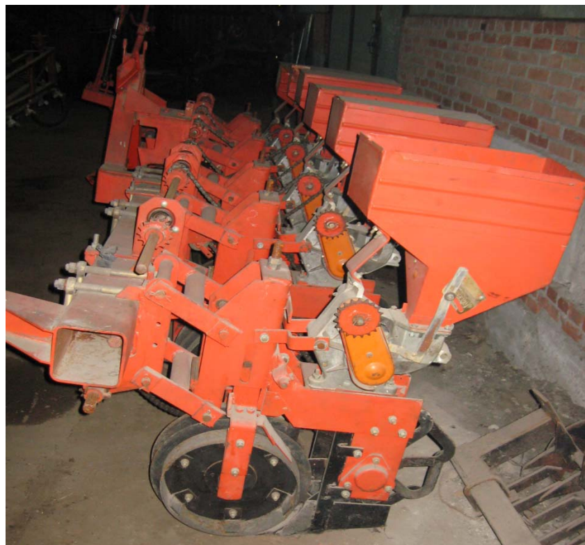
Рис. 1. Комбинированная машина для предпосевной обработки почвы и посева
