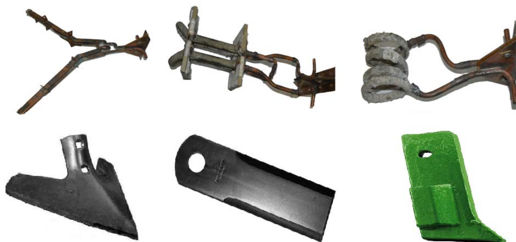
Рис. 1. Рабочие органы сельскохозяйственных агрегатов и индукторы для их индукционного нагрева
