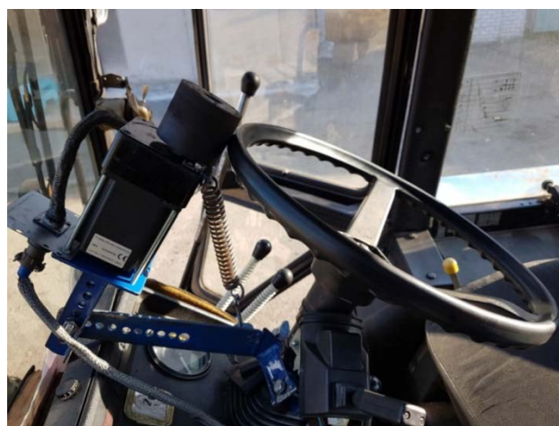
Рис. 2. Электродвигатель с кронштейном крепления
