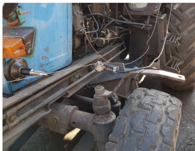
Рис. 3. Крепление датчика угла поворота управляемых колес
