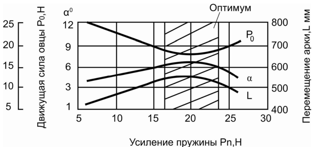
Рис. 5. Зависимость силы воздействия овцы P_0 на пластину, перемещения арки L и угла наклона \alpha от усилия пружины P_n
