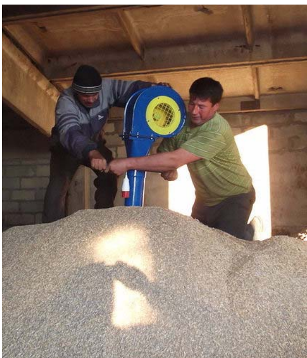
Рис. 1. Склад зерна (установка аэратора зерна)
