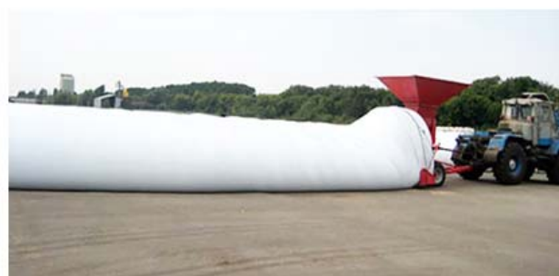
Рис. 4. Загрузка зерна в рукав
