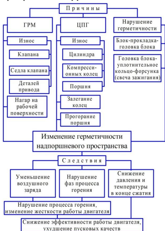
Рисунок 1. Причинно-следственная связь изменения герметичности надпоршневого пространства
