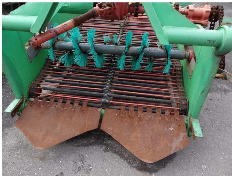
Рисунок 2. Выкапывающие лемеха и щеточно-шнековый интенсификатор
