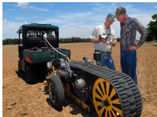
Рисунок 1. Прицепные агрегаты для автоматизированного забора проб грунта: слева – Falcon [1]; справа – AutoProbe [2]
