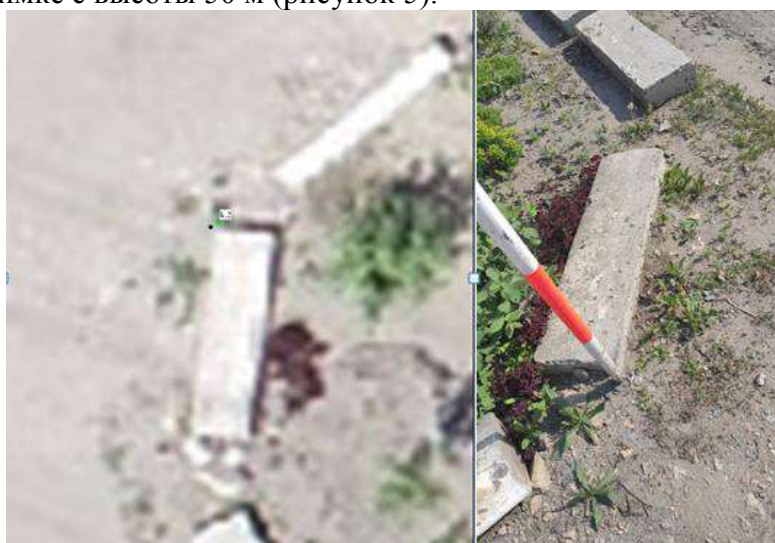
Рис. 5. Пример установки контрольных точек
