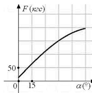
**Решение.** Из графика видно, что сила натяжения достигает 150 кгс при угле наклона 45 градусов.
