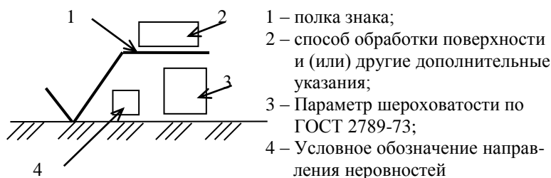
Рисунок 5.4 – Условный знак обозначения шероховатости поверхности
