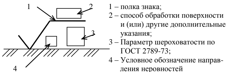
Рисунок 5.4 – Условный знак обозначения шероховатости поверхности
